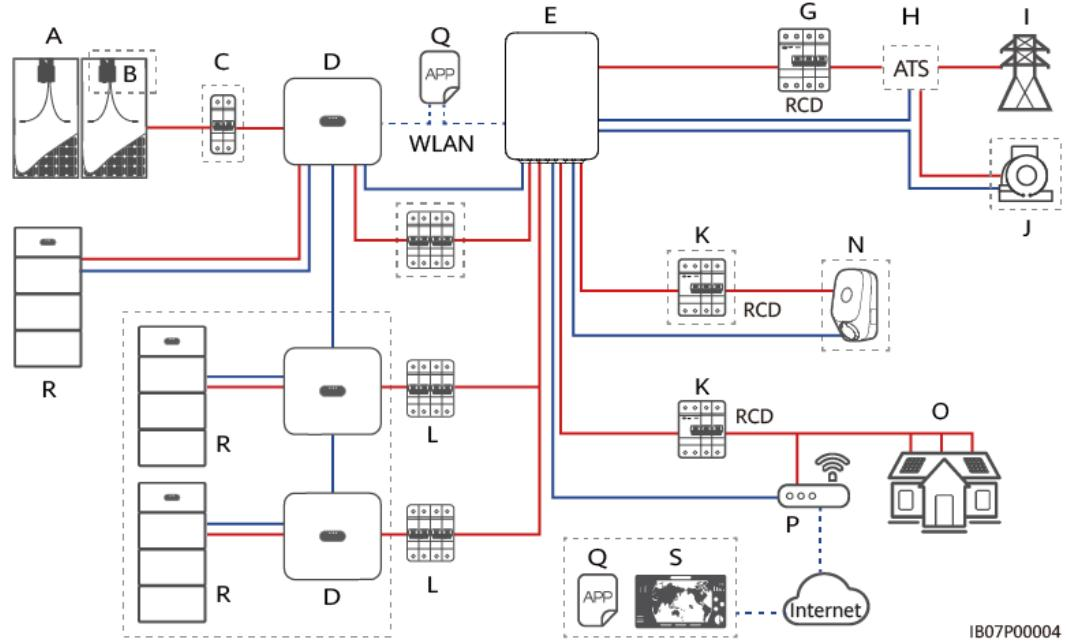
**Figura 2-5** Conexión en red con algunas cargas conectadas al SmartGuard (los recuadros de rayas pequeñas indican los componentes opcionales)
