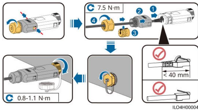
**Figura 5-42** Instalación de componentes antirrobo para el Smart Dongle
