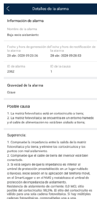
Figura K-1 Detalles de la alarma
