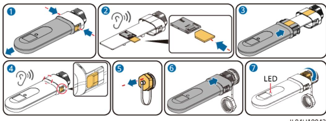
**Figura 5-37** Instalación de componentes antirrobo para el Smart Dongle
