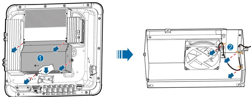
**Paso 3** Desconecte el cable del ventilador, quite la ménsula del ventilador y desinstale el ventilador defectuoso.
