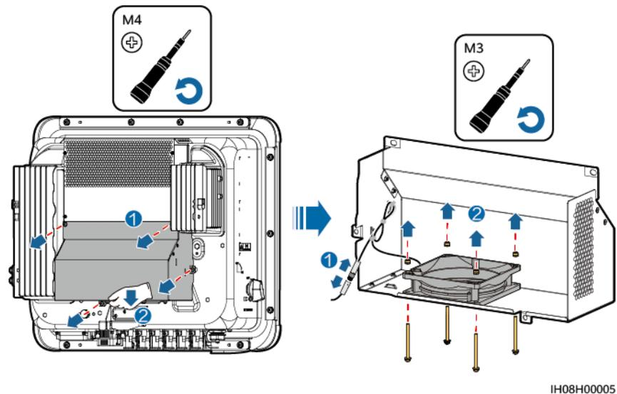
**Paso 3** Instale un ventilador nuevo, conecte y ate los cables, e instale la tapa del ventilador.
