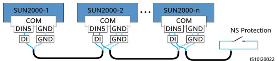
**Paso 1** Conecte los cables de señal al conector correspondiente (para la conexión en cascada de los inversores).
