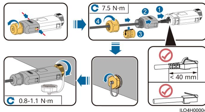
Figura 5-45 Instalación de componentes antirobo para el Smart Dongle
