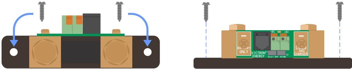
Vista superior del shunt mostrando los orificios de montaje y vista lateral del shunt mostrando el método de montaje.
