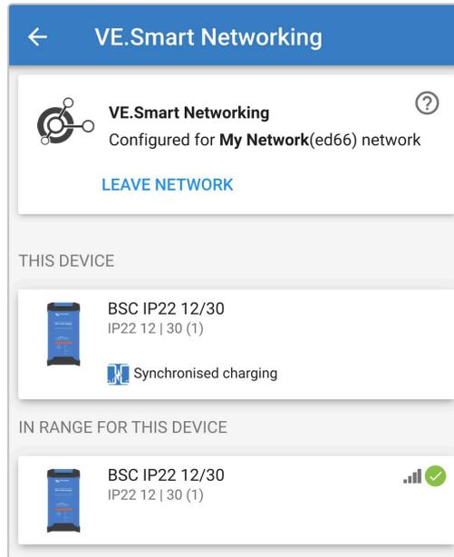
17. Para sistemas con cargadores compatibles con VE.Smart networking adicionales conectados a la misma batería/bancada de baterías, repita los pasos 9 a 17 para incluir cada uno de los cargadores que faltan en la misma red VE.Smart.
