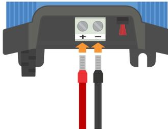
D. Apriete los tornillos del terminal hasta 2,4 Nm con una llave dinamométrica y una cabeza de destornillador adecuadas y vuelva a colocar la tapa de las conexiones.
