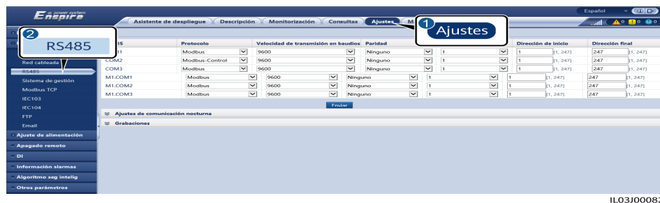
Figura 6-85 Configuración de los parámetros de RS485
