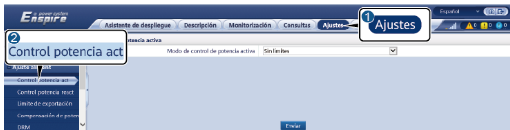
Figura 6-71 Control de potencia activa
