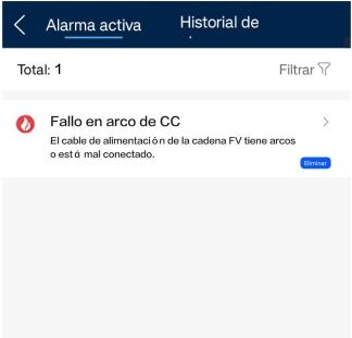
Figura 7-2 Eliminación de la alarma
